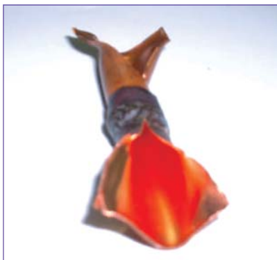
Пайка в присутствии азота
