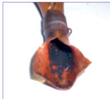
Пайка без использования азота
